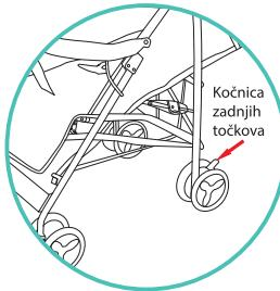
2. Kočnica: Kada privremeno zaustavljate/parkirate kolica, trebalo bi da pritisnete dugme kao na slici i zakočite kolica.
