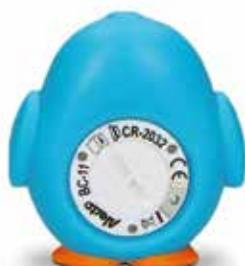
Koristite novčić da biste okrenuli poklopac baterije u smeru suprotnom od kretanja kazaljke na satu. Umetnute mali odvijač u izrez da biste uklonili poklopac. Instalirajte novu bateriju (CR2032) pozitivnom stranom prema gore. Vratite poklopac i novčićem rotirajte poklopac u smeru kazaljke na satu.
